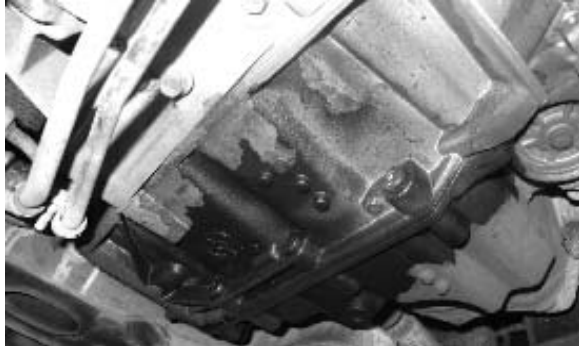
图 1.2 某发动机机油泄漏示意图
