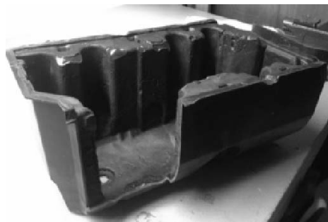
图 1.5 某油底壳通过增加吸音材料降噪
