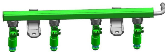
(b) 燃油分配器总成方形主油管优化设计数模
