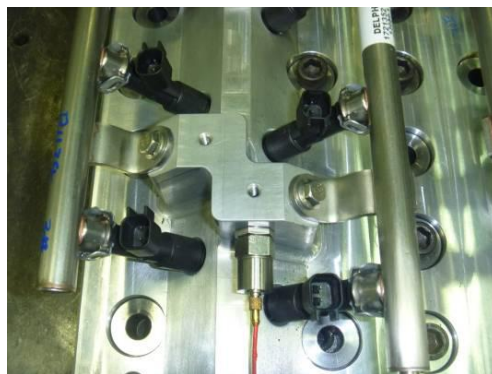
(b) 燃油分配器总成在振动工装上模拟实车坐标的固定
