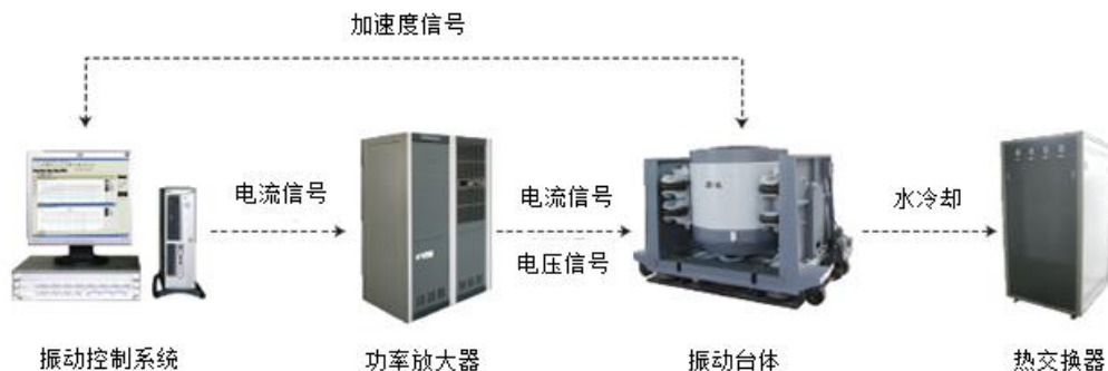
图 3.2 振动试验工作路径
