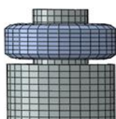
(b) 燃油喷射器系统上端部 O 型圈网格模型
