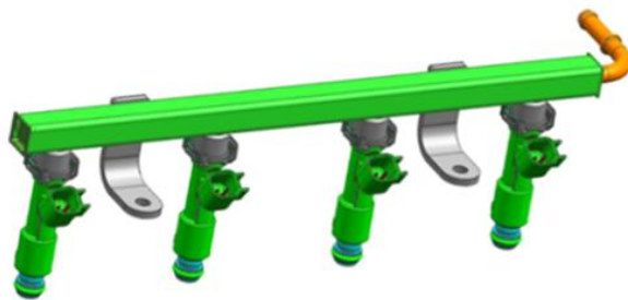
(a) 燃油分配器总成支架失效设计数模
