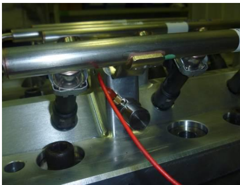
(c) 振动台上振动传感器的布置
