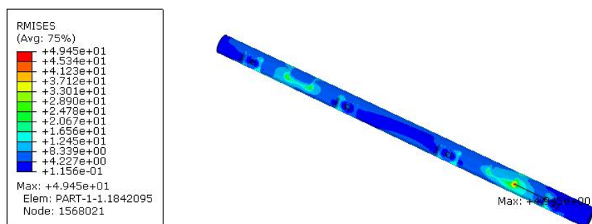
(a) 主油管结构的等效力云图
