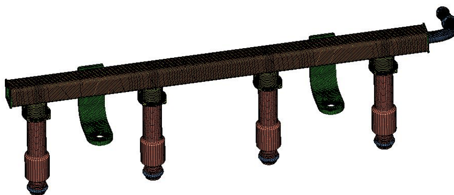
(a) 燃油分配器总成网格模型
